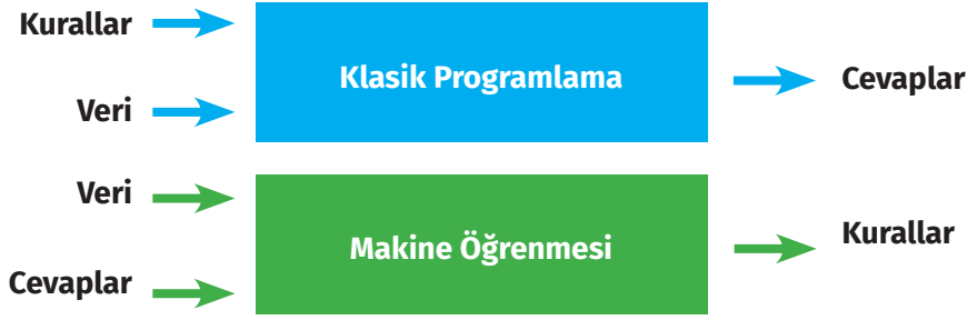
Görsel 2.4.1. Klasik programlama ve makine öğrenmesi yaklaşımlarının karşılaştırılması (Géron, 2017)
