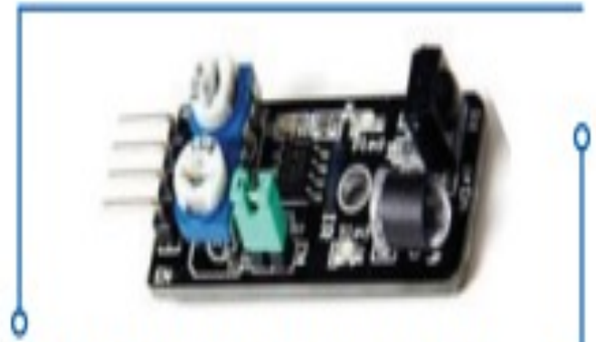
Resim 5.5: Engel kaçınma algılayıcı
