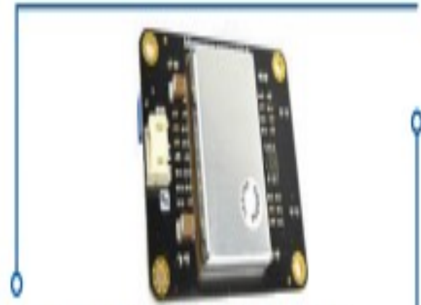
Resim 5.13: Mikrodalga hareket dedektörü algılayıcı
