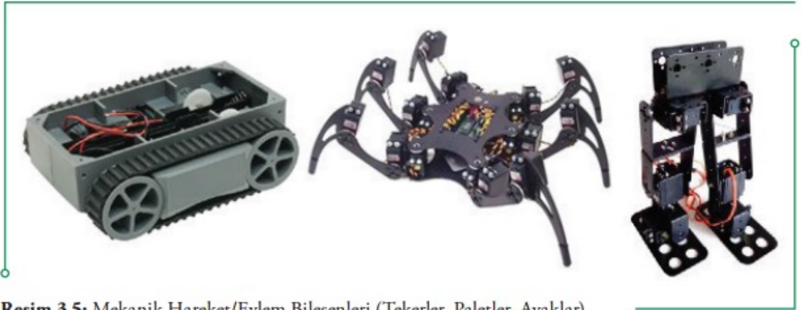
Resim 3.5: Mekanik Hareket/Eylem Bileşenleri (Tekerler, Paletler, Ayaklar)
